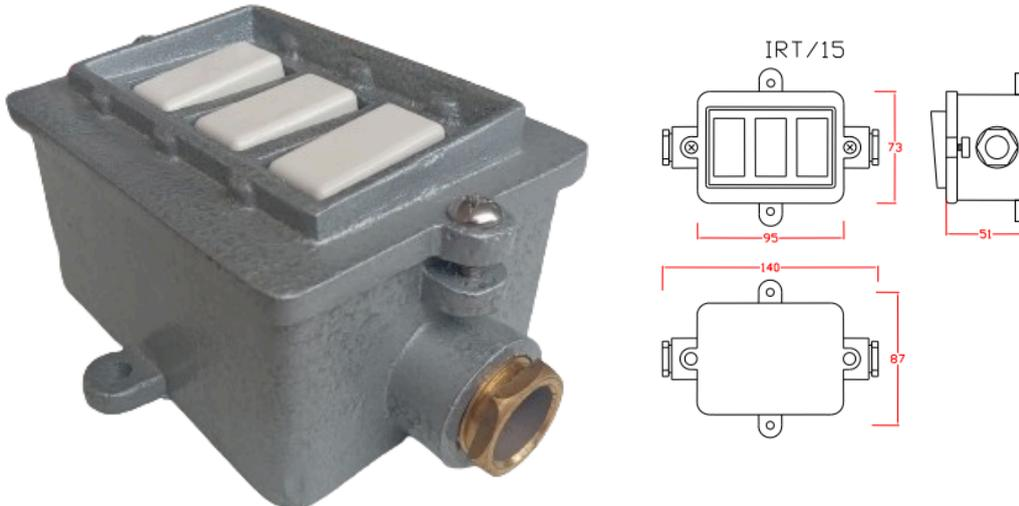
**CUERPO:** Estructura de aleación de aluminio fundido. Pernos galvanizados de 5/32" Ø. Dado italiano de 15A. Pintura al horno color gris martillado.
