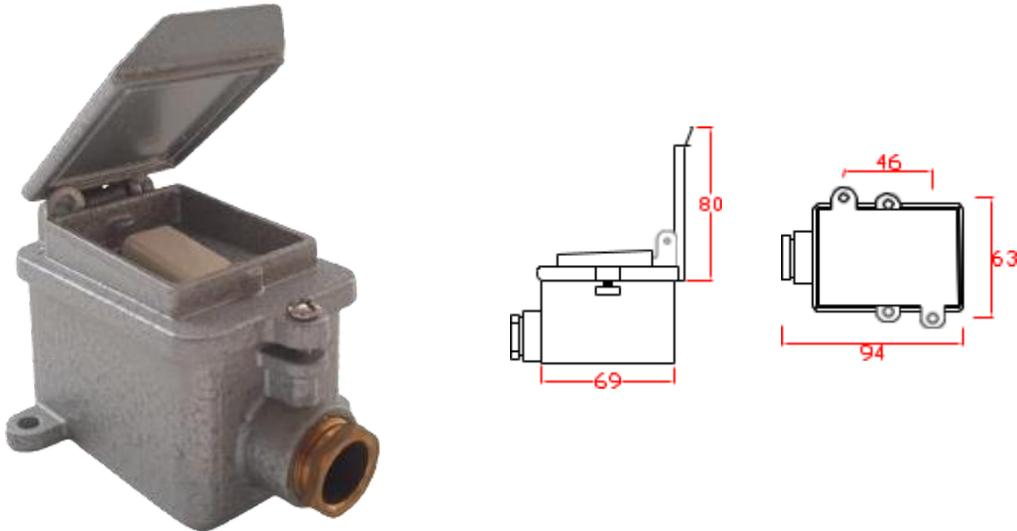
**CUERPO:** Estructura de aleación de aluminio. Stove bolts de acero inoxidable. Dados italianos de 15 A. Pintura al horno color gris martillado. Conexión con cable vulcanizados o tubería eléctrica de ½" NPT.
