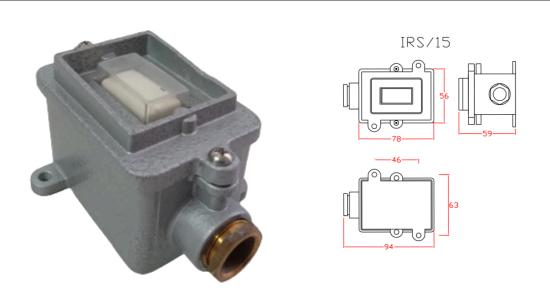
**CUERPO:** Estructura de duraluminio inyectado. Pernos galvanizados de 5/32" Ø. Dado italiano de 15A. Pintura al horno color gris martillado.
