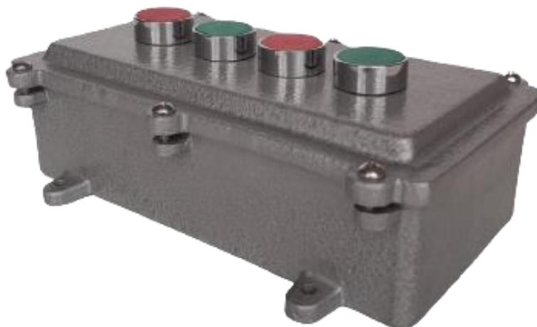
**CUERPO:** Estructura de aleación de aluminio fundido. Pernos galvanizados de 5/32". Pintura al horno de color gris martillado para una mayor protección y durabilidad del producto.
