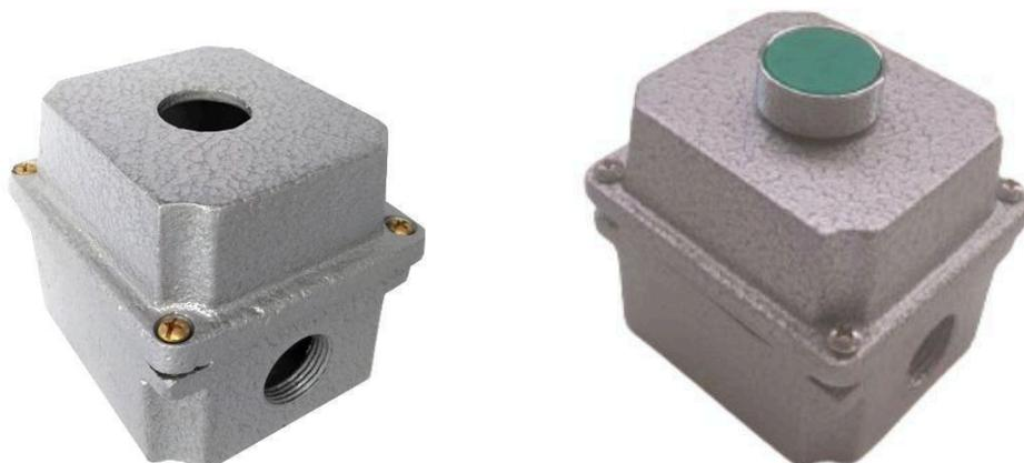
**CUERPO:** Estructura de aleación de aluminio fundido. Stove bolts galvanizados de 5/32". Una salida para 1/2 NPT (2 salidas a pedido del cliente). Pintura al horno de color gris martillado para una mejor protección y durabilidad del producto.
