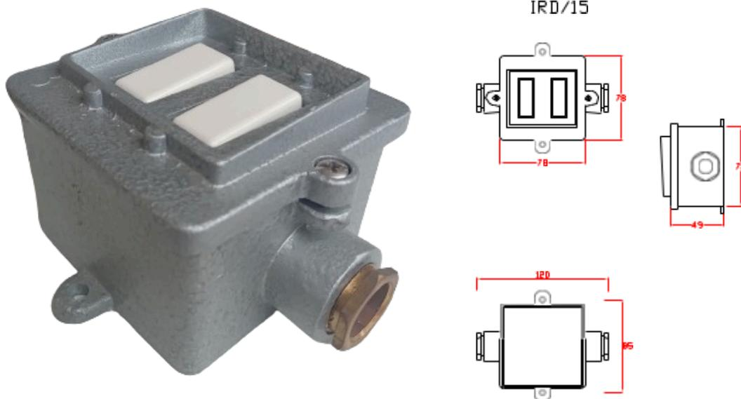
**CUERPO:** Estructura de duraluminio inyectado. Pernos galvanizados de 5/32" Ø. Dado de 15 A. Pintura al horno color gris martillado.
