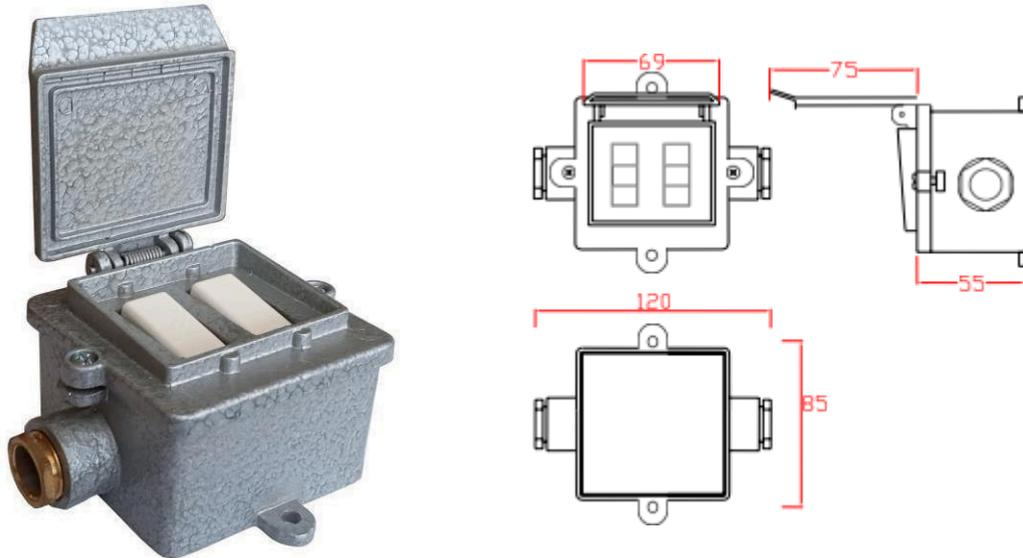
**CUERPO:** Estructura de aleación de aluminio. Stove bolts de acero inoxidable. Dados italianos de 15A. Pintura al horno color gris martillado. Conexión con cable vulcanizados o tubería eléctrica de ½" NPT.
