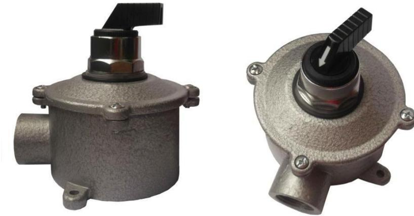
**CUERPO:** Estructura de aleación de aluminio fundido. Stove bolts de acero inoxidable de 5/32". Salida para tubo 3/4 NPT. Pintura al horno de color gris martillado para una mejor protección y durabilidad del producto.
