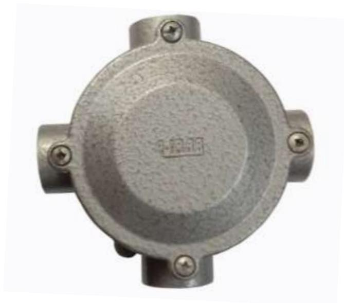
**CUERPO:** Estructura de aluminio fundido, tapa con 4 stove bolts galvanizados de 5/32" Ø y 4 salidas de 3/4 NPT.
