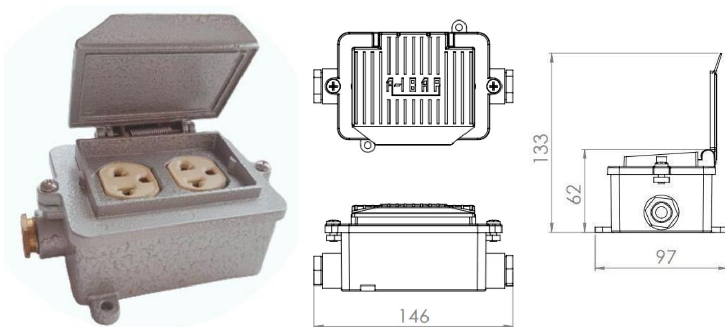
**CUERPO:** Estructura de aluminio fundido. Pernos galvanizados de 5/32" Ø. Tomacorriente de **20 AMP universal**. Pintura al horno color gris martillado.
